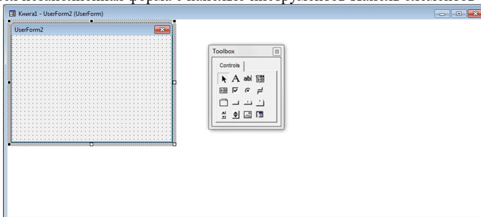
Рис. 7. Окно форм VBA с панелью инструментов
