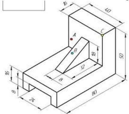
6. На листе чертежной бумаги формата А4 по заданным проекциям построить третью проекцию модели в проекционной связи в масштабе 1:1. Нанести необходимые размеры в соответствии с нормами ГОСТ.
