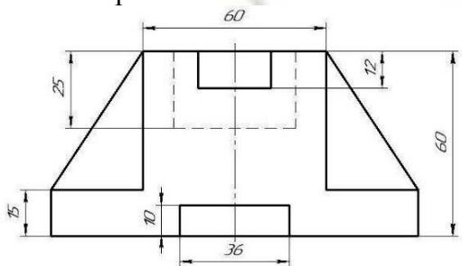
5. На листе чертежной бумаги формата А4 построить три проекции модели по аксонометрическому изображению в проекционной связи в масштабе 1:1. Построить проекции
