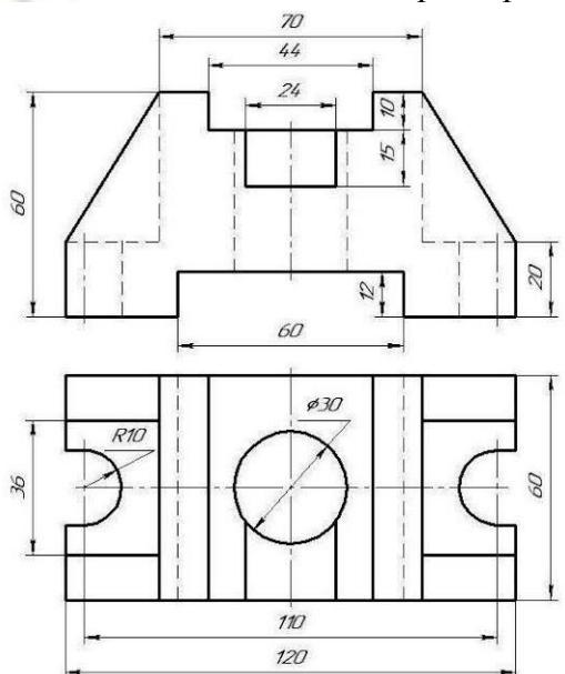
8. На листе чертежной бумаги формата А4 по трем проекциям модели построить прямоугольную и косоугольную (фронтальную) изометрию в масштабе 1:1.
