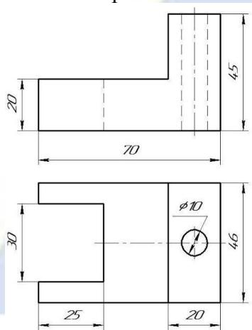
7. На листе чертежной бумаги формата А4 по заданным проекциям построить третью проекцию модели в масштабе 1:1. Совместить  $\frac{1}{2}$  вида с  $\frac{1}{2}$  разреза на фронтальной и боковой проекциях. Нанести необходимые размеры в соответствии с нормами ГОСТ
